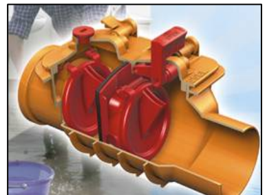
Abb.: das Innere einer Rückstausicherung für fäkalienfreies Abwasser. Die Rückstauklappen öffnen nur in Ablafrichtung. Von außen eindringendes Wasser wird dagegen gesperrt (Quelle: Kessel)
