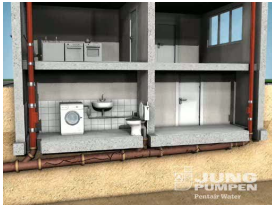
Abb.: Erneuerung einer schwer zugänglichen Leitung durch stilllegen des Altröhre und abhängen der neuen Leitung unterhalb der Decke (Quelle: Jung Pumpen)
