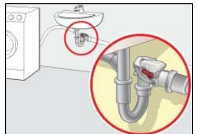
Abb.: Mini-Rückstausicherung am Siphon-Ablauf (Quelle: Kessel)
