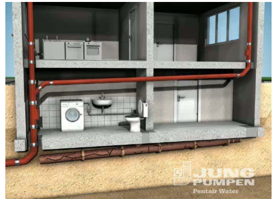
Abb.: Erneuerung einer schwer zugänglichen Leitung durch stilllegen des Altröhre und abhängen der neuen Leitung unterhalb der Decke (Quelle: Jung Pumpen)
